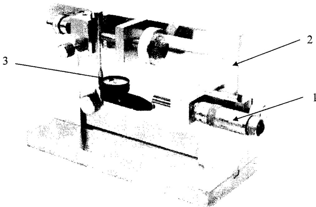
1 – головка микрометрическая, 2 – приспособление, 3 – поверяемый индикатор
