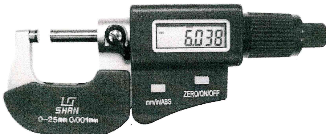
Рисунок 5 – Общий вид микрометров с цифровым отсчетным устройством
