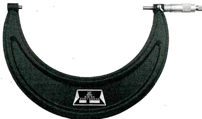
Рисунок 3 – Общий вид микрометров с отсчетом по шкалам стебля и барабана
